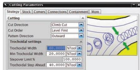
NX 中的摆线切削模式可以根据用户指定的标准自动防止您超出容许的切削条件。
